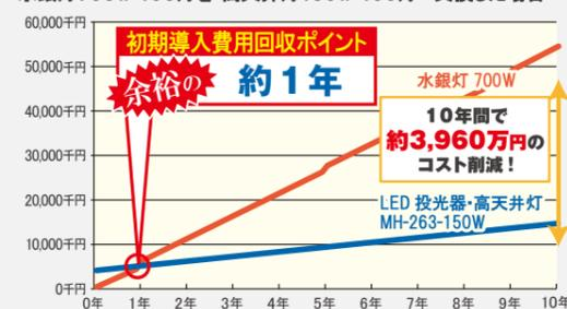
●MH-263-150W設置の比較になります。●LED初期導入費用と工事費を含めた回収試算になります。
