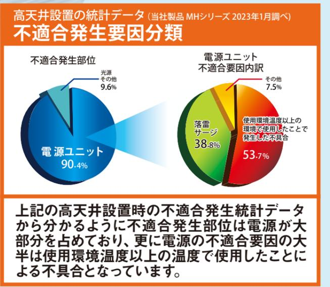
上記の高天井設置時の不適合発生統計データから分かるように不適合発生部位は電源が大部分を占めており、更に電源の不適合要因の大半は使用環境温度以上の温度で使用したことによる不具合となっています。
